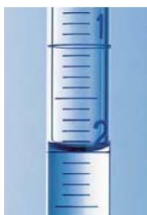
Ajuste de menisco a 2 mL en una pipeta graduada
