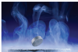
Imán suspendido sobre un superconductor enfriado por debajo de su temperatura de transición mediante nitrógeno líquido.
