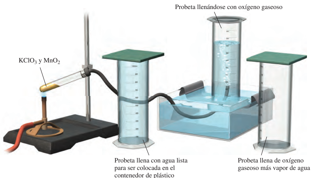
Figura 5.15 Aparato para recolectar un gas en agua. El oxígeno generado mediante el calentamiento del clorato de potasio ( \text{KClO}_3 ) en presencia de una pequeña cantidad de dióxido de manganeso ( \text{MnO}_2 ), el cual acelera la reacción, se hace burbujear en el agua y se recoge en una probeta como se muestra. El oxígeno gaseoso desplaza el agua que originalmente estaba presente en la probeta hacia la tina.
