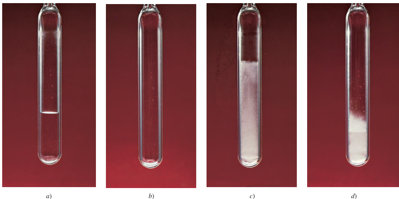
Figura 11.37 Fenómeno crítico del hexafluoruro de azufre. a) Por debajo de la temperatura crítica es visible la fase líquida transparente. b) Por encima de la temperatura crítica la fase líquida desaparece. c) La sustancia se enfría apenas por debajo de su temperatura crítica. La neblina representa la condensación del vapor. d) Por último, la fase líquida reaparece.
