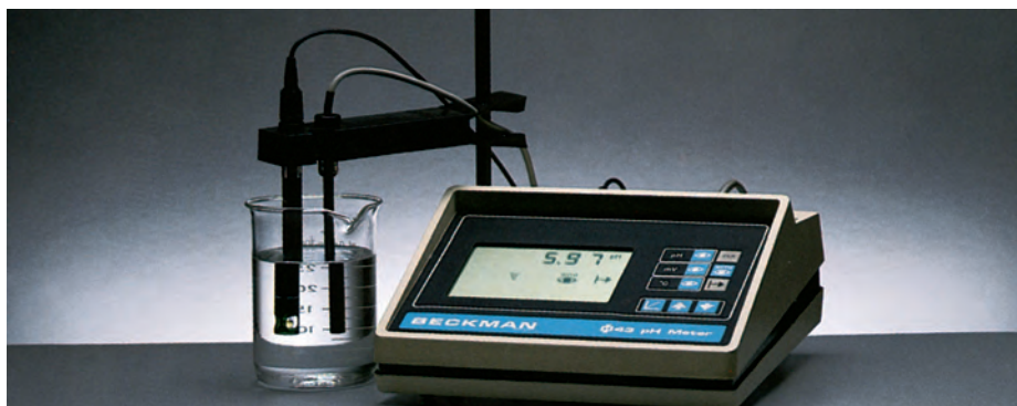
Figura 15.2 Un medidor del pH se utiliza comúnmente en el laboratorio para determinar el pH de una disolución. A pesar de que muchos medidores del pH tienen escalas marcadas con valores que van de 1 a 14, los valores del pH, de hecho, pueden ser menores a 1 y mayores que 14.
