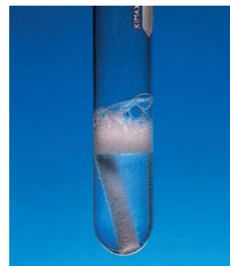
Figura 4.6 Un pedazo de tiza para pizarrón, compuesta principalmente por \text{CaCO}_3 , reacciona con ácido clorhídrico.
