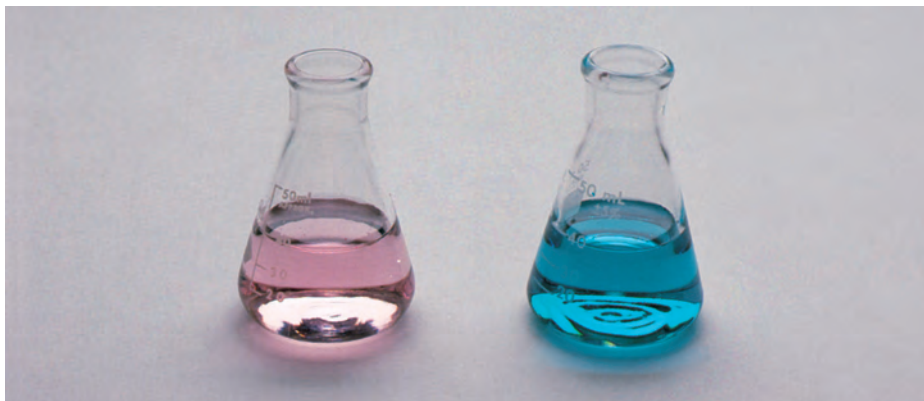
Figura 16.10 (Izquierda) Disolución acuosa de cloruro de cobalto(II). El color rosa se debe a la presencia de iones \text{Co}(\text{H}_2\text{O})_6^{2+} . (Derecha) Después de la adición de una disolución de HCl, la disolución se torna azul debido a la formación de iones complejos \text{CoCl}_4^{2-} .
