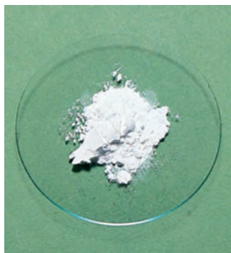
Fluoruro de litio. Industrialmente, el LiF (como la mayoría de los demás compuestos iónicos) se obtiene al purificar minerales que contienen el compuesto.
