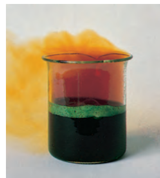
Figura 22.7 Producción de NO_2 gaseoso cuando el cobre reacciona con ácido nítrico concentrado.
