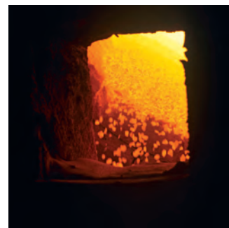
La producción de cal viva ( \text{CaO} ) a partir de piedra caliza ( \text{CaCO}_3 ) en un horno rotatorio.
