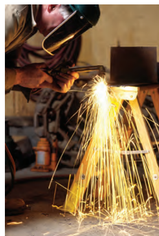
La temperatura de la flama de un soplete oxiacetilénico es muy alta ( 3\,000^\circ\text{C} ) y se utiliza para soldar metales.
