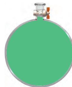
Figura 5.12 Aparato para medir la densidad de un gas. Un bulbo de volumen conocido se llena con el gas bajo estudio a cierta temperatura y presión. Primero se pesa el bulbo, y después se vacía (evacua) y se vuelve a pesar. La diferencia en las masas proporciona la masa del gas. Si conocemos el volumen del bulbo, podemos calcular la densidad del gas. En condiciones atmosféricas, 100 mL de aire pesan alrededor de 0.12 g, una cantidad fácilmente cuantificable.
