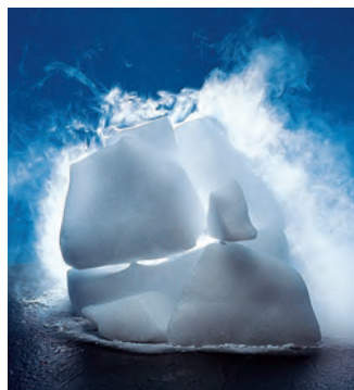
Figura 11.42 En condiciones atmosféricas, el dióxido de carbono sólido no se funde; sólo puede sublimarse. El dióxido de carbono gaseoso frío ocasiona que el vapor de agua cercano se condense y forme una neblina.
