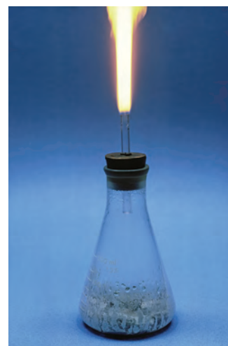
La reacción del carburo de calcio con agua produce acetileno, un gas inflamable.
