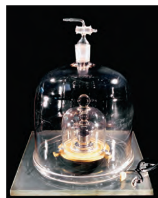
Figura 1.9 El kilogramo prototipo está hecho de una aleación de platino e iridio. Se conserva en un depósito de seguridad en la Oficina Internacional de Pesos y Medidas que se encuentra en Sèvres, Francia. ¡En 2007 se descubrió que la aleación ha perdido en forma misteriosa aproximadamente 50 \mu g!
