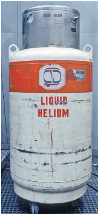
Tanque de almacenamiento criogénico de helio líquido.
