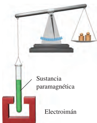
Figura 7.26 Inicialmente la sustancia paramagnética se pesó en una balanza en ausencia de un campo magnético. Cuando el electroimán se encendió, la balanza se desequilibró debido a que el tubo de muestra fue atraído por el campo magnético. Una vez que se conoce la concentración y la masa adicional necesaria para restablecer el equilibrio, es posible calcular el número de electrones desapareados en la sustancia.
