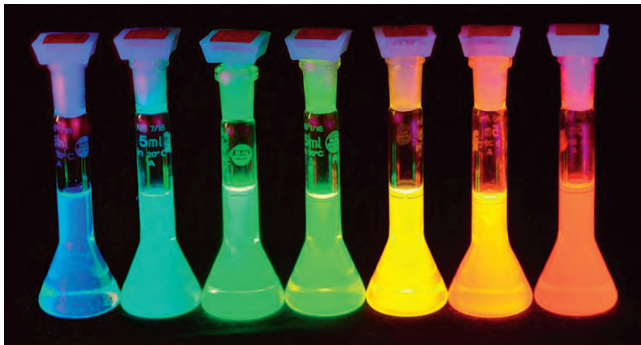
Emisión de soluciones dispersas de puntos cuánticos de CdSe ordenados de izquierda a derecha en el orden de diámetro creciente (2 nm a 7 nm).
