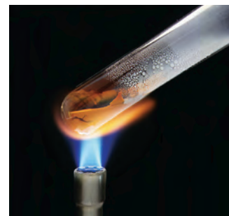
Al calentar el \text{HgO} se descompone para producir \text{Hg} y \text{O}_2 .
