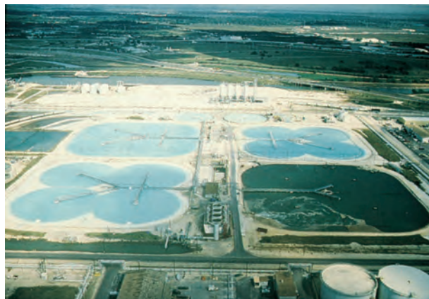
El hidróxido de magnesio se obtiene del agua del mar en estanques de sedimentación en Dow Chemical Company que una vez operó en Freeport, Texas.
